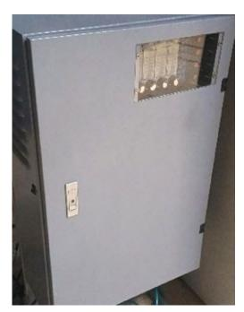
Générateur d'Ozone à décharge corona destiné au lavage textile et utilisé par le CTTN.
